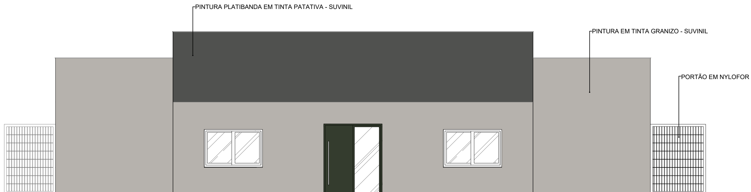
FACHADA A SEM MURO ESC.: 1:75
